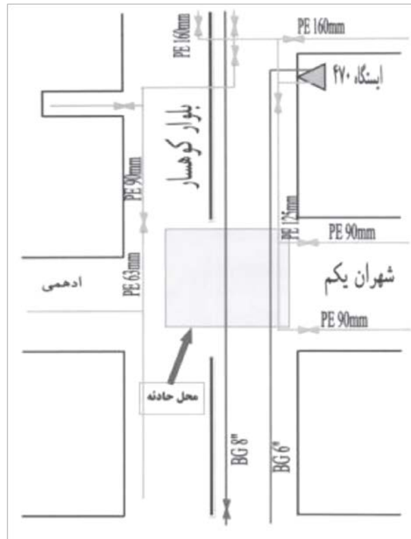
شکل ۱۰- کروکی لوله‌های گاز
