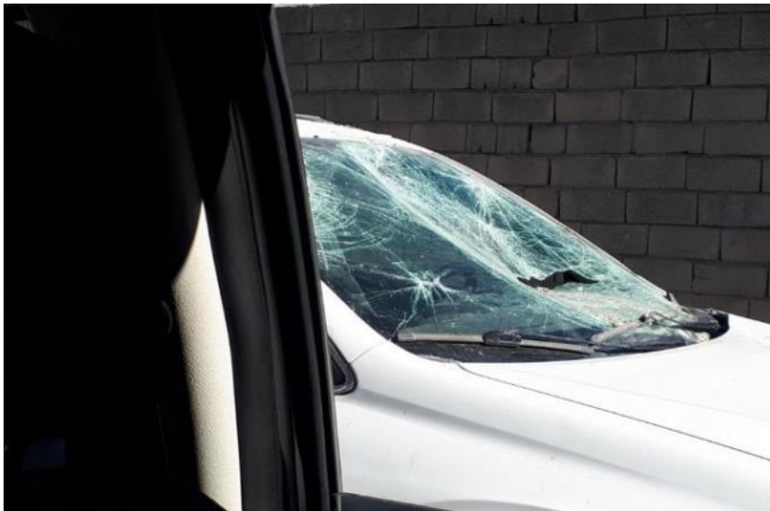
شکل ۸۴-۲ آسیب دیدگی برخی از خودروها در اثر سقوط مصالح دیوارهای ساختمان ها
